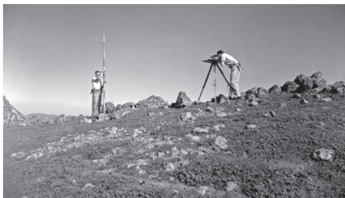
Fig. 6. Surveying using plane table and alidade. Image: Geoscience Australia, no date.
